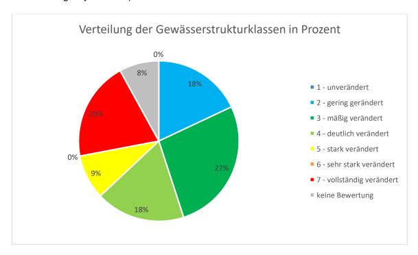
Die Strukturklasse 3 wird als Mindestziel angestrebt. 55% der Länge sollten also strukturell aufgewertet werden. Wegen der Staubereiche wird dies nicht erreicht.
